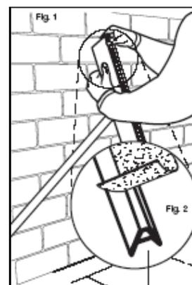
3. Comience a instalar la Fibra Easy Trap por un extremo del Soporte, presionando la Fibra por la zona de sujeción. Alinee el límite de la Fibra con el de la zona de agarre del Soporte (Figura 2).
